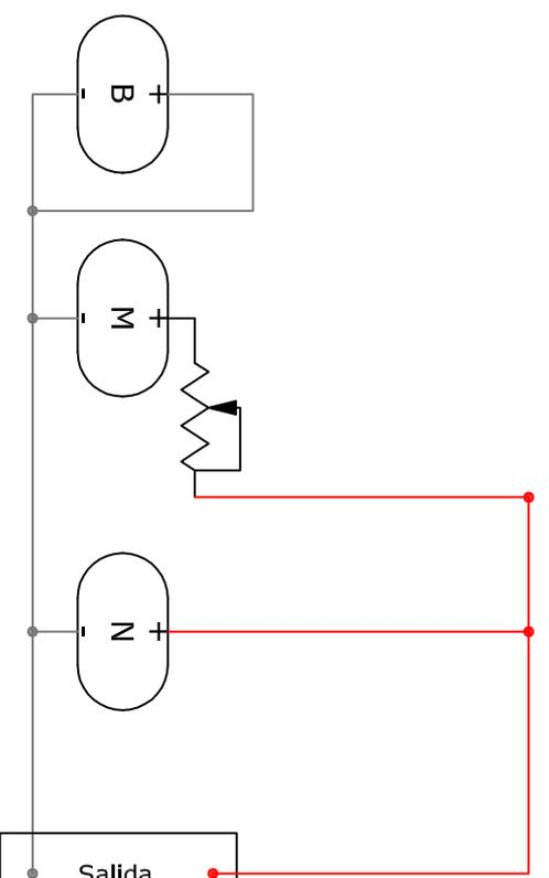
Pastillas del mástil y central en paralelo (posición 4 clásica de Strato).
