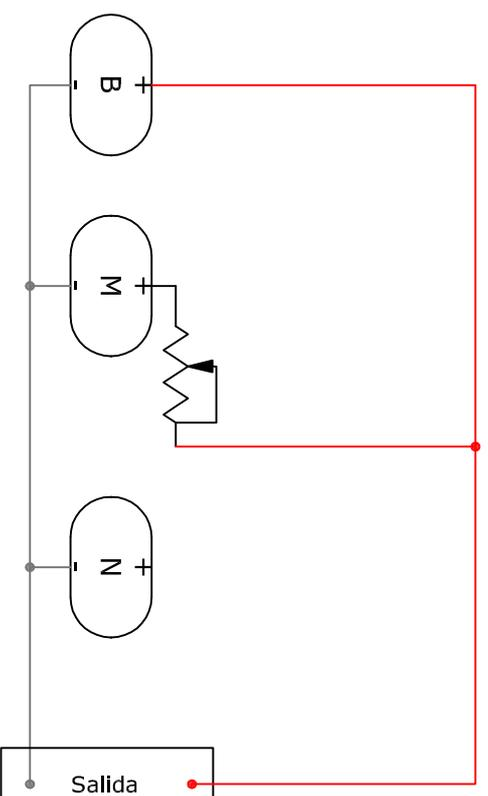
Pastilla del puente y central en paralelo (posición 2 clásica de Strato).
