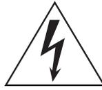
El símbolo del rayo significa que existen voltajes peligrosos sin aislar en el interior de la unidad, que pueden ser de magnitud suficiente para constituir un riesgo de electrocución.
