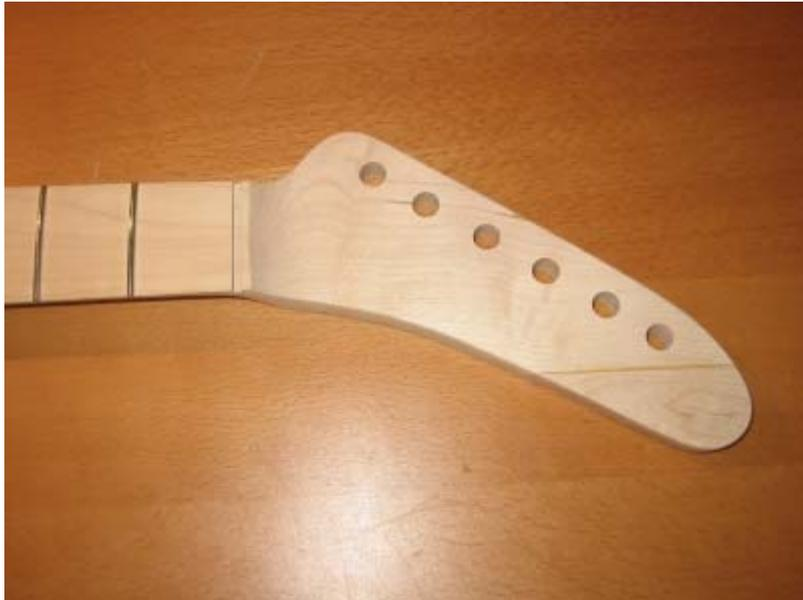
El mástil necesita un pulido general de los trastes, sobretodo en el borde, pero en general es de muy buena calidad, así que lo siguiente es coger limas y lija, y realizar el terminado de los mismos.....además de realizar el hueco para la cejilla de bloqueo del tremolo Floyd, pero eso lo hice después de la pintura.
