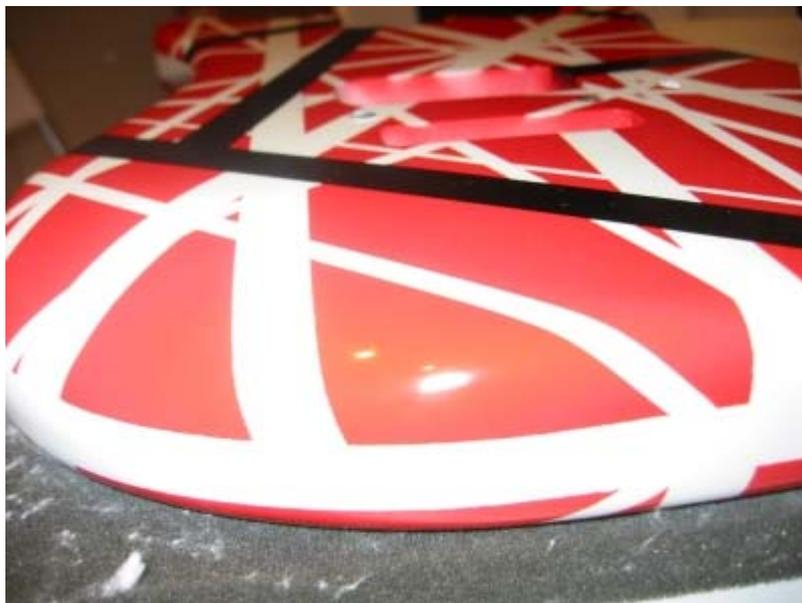
Tras el pulimento, aplico un producto habitual en el mantenimiento de guitarras como pulido final, resultando una superficie brillante y pulida a modo de espejo, bastante difícil de apreciar en las fotos.
