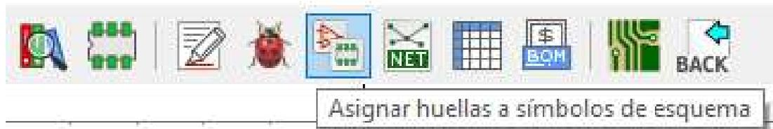
En esta sección, una vez que es ejecutada, se realiza una conexión a internet y se descargan las huellas referentes a cada uno de los tipos de componentes empleados en el proyecto. Aparecerán tres columnas:
