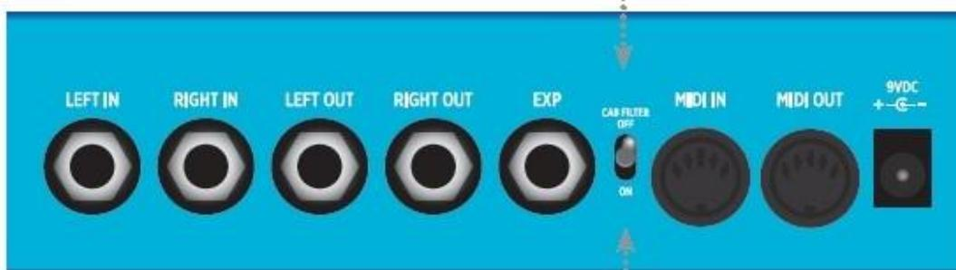
Si la salida da a un sistema gama completa PA, una interfaz de grabación, o auriculares, ponga el BigSky en el último lugar de su cadena de efectos y ajuste el interruptor FILTER CAB en la posición ON. Esto hará involucrar a nuestra sofisticada curva de respuesta del altavoz. La suciedad de los pedales sonará como amperios, y su guitarra limpia tendrá una presente respuesta aún redondeada incluso sin un amplificador.
