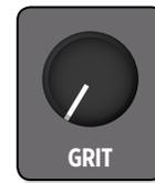
**BUCKET LOSS:** En dBucket, el botón GRIT ejerce la función de BUCKET LOSS. Controla la cantidad de elementos dBucket perdidos en cada fase del algoritmo dBucket, desde 'pérdida cero' en la posición mínima hasta 'pérdida total' en la posición máxima. Ajuste el botón a las 3:00 horas para obtener una máxima pérdida de distorsión con una cantidad de ruido mínima. A medida que gire el botón hacia la derecha, el ruido será más notable.
