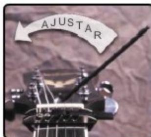
Para ajustar el Tensor, revisa la entonación, después instala un capo en el 1er traste y presiona la 6ta cuerda en el último traste. Con un medidor, revisa la separación entre la parte inferior de la cuerda y la parte superior del 8vo traste - la medida deberá ser aproximadamente .010" (.2540 mm).
