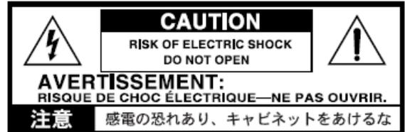
El símbolo del rayo significa que existen voltajes peligrosos sin aislar en el interior de la unidad, que pueden ser de magnitud suficiente para constituir un riesgo de electrocución.
