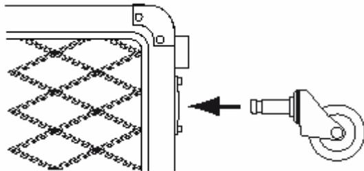
Pulse con fuerza las patas con ruedas hasta que entren completamente en el chasis.
