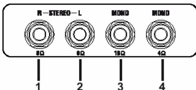
1. Conexión Estéreo 8 ohmios. Use esta conexión cuando conecte el canal derecho de un combo Estéreo o amplificador.
