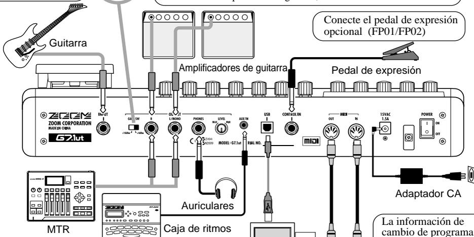
Utilice un cable stereo en Y para conectar una caja de ritmos (ZOOM RT-223 o similar) o un reproductor de CD/MD, etc. La señal enviada a la toma AUX IN no es procesada por los efectos internos; es enviada sin modificación a las tomas OUTPUT L/MONO y OUTPUT R. La señal es enviada también al puerto USB.
