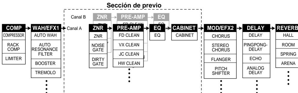
En algunos módulos de efectos, puede elegir un tipo de efecto entre una serie de opciones. Por ejemplo, el módulo MOD/EFX2 le permite elegir entre CHORUS, FLANGER y otros tipos de efectos.
